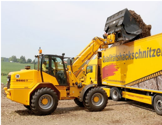
Nur knapp 20 Minuten dauert das Beladen des 94 Schüttraummeter fassenden Schubbodensattelzuges mit dem 9660 T und der Großraum-Hochkippschaufel. Die Hubhöhe mit eingefahrenem Teleskoparm beträgt beachtliche 4,80 m.
